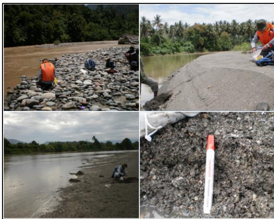
Gambar 4. Pengambilan sampel pasir pada point bar dan channel bar sungai.
