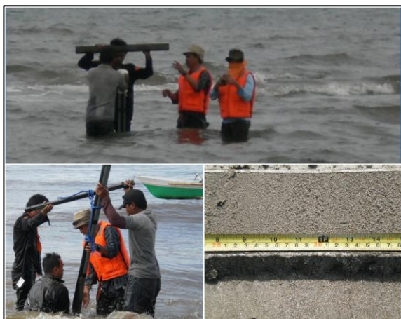
Gambar 5. Pengambilan sampel pasir secara coring pada stasiun 7 (muara sungai).
