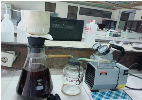
Gambar 7. Penyaringan dengan kertas saring whatman 41
