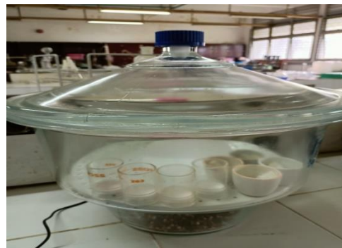
Gambar 10. Desikator tempat mendinginkan sampel
