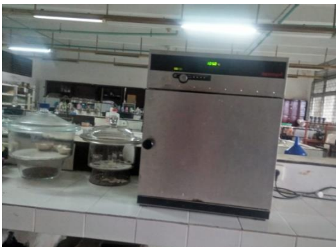
Gambar 9. Oven . Sampel dikeringkan pada suhu 105 0 C
