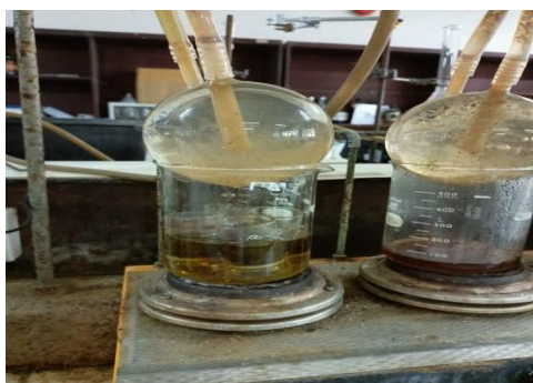
Gambar 5. Gelas filter yang telah berisi sampel direbus dalam gelas piala 500 ml
