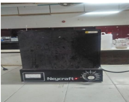
Gambar 9. Tanur untuk mengabukan sampel
