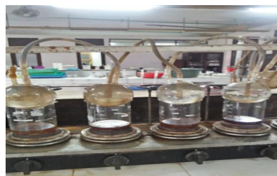
Gambar 6. Gelas piala berisi sampel yang direbus dalam larutan asam dan basa
