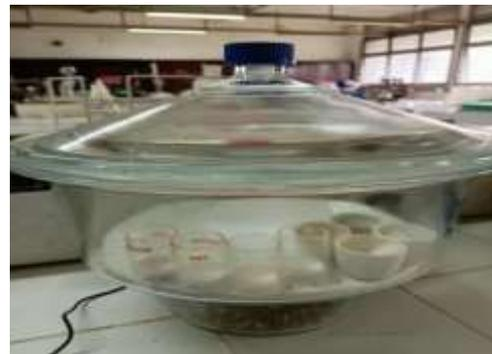
Gambar 10. Desikator tempat mendinginkan sampel
