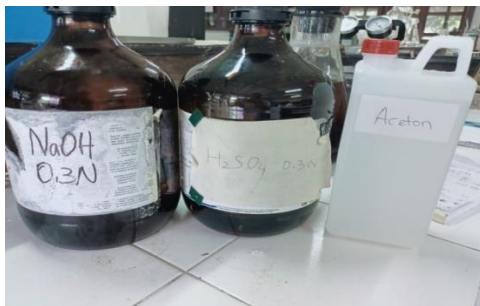
Gambar 3. Bahan kimia untuk serat kasar H_2SO_4 0,3 N, NaOH 0,3 N dan aseton
