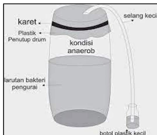
**Gambar 2. Skema alat pembuatan MOL**
